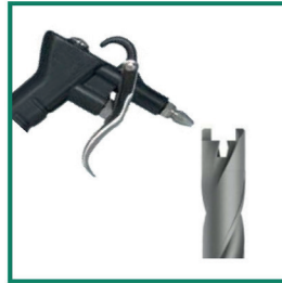
Schnittstelle ausblasen Use air blast to clean
